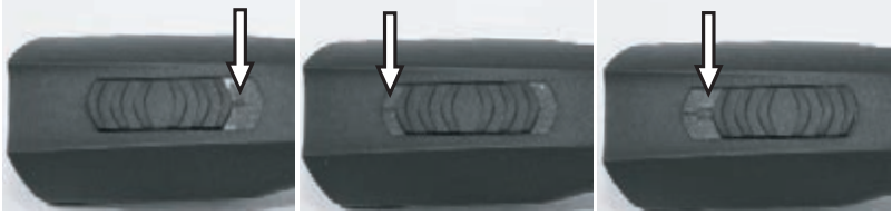
Afb. 4 Schakelaar positie UIT ("0")
